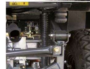
Fiabilité de la suspension arrière semi-indépendante renforcée
