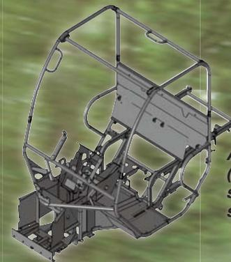
Arceau de sécurité (ROPS) en standard sur le robuste cadre de structure du châssis
